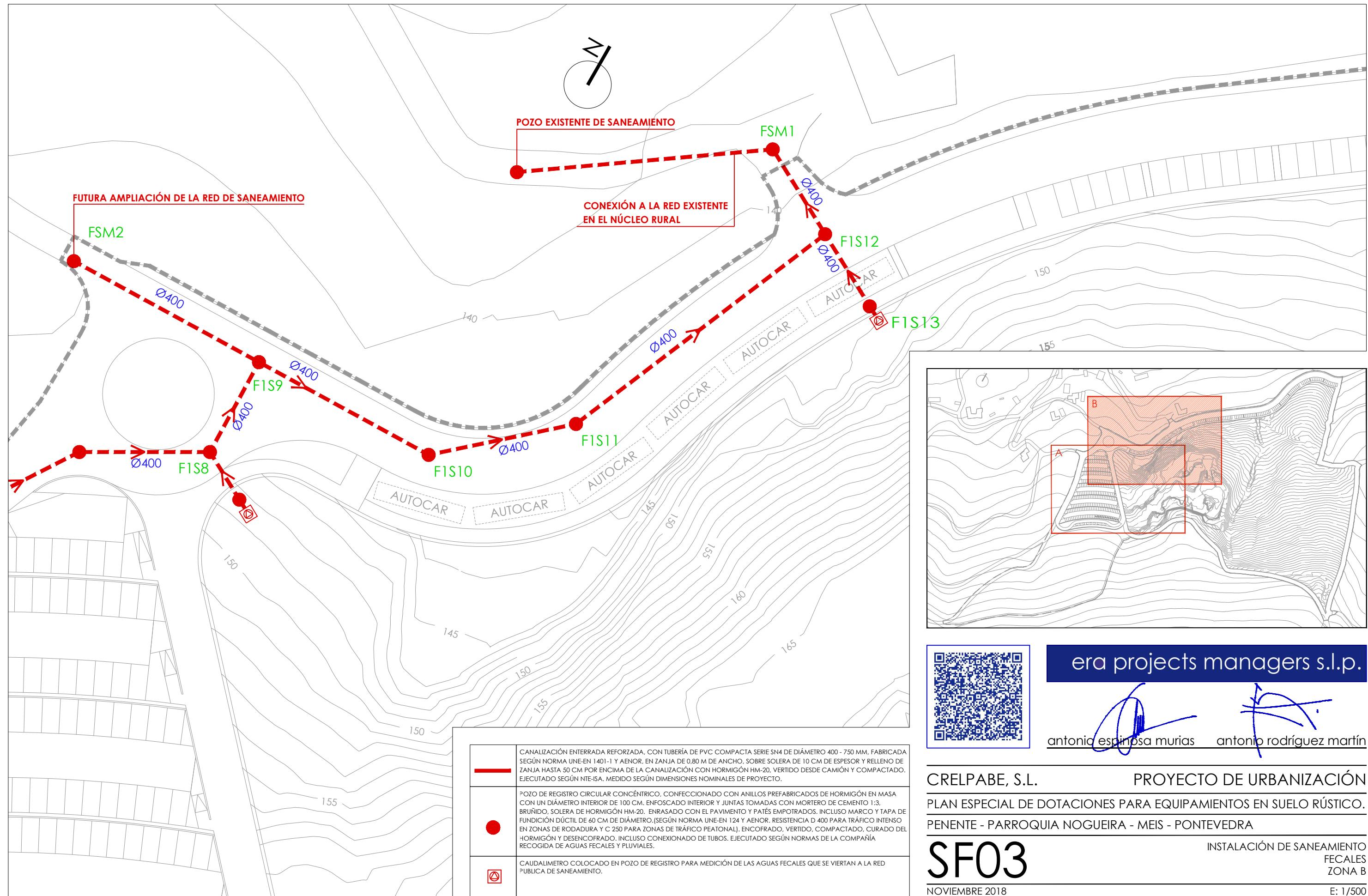
CANALIZACIÓN ENTERRADA REFORZADA, CON TUBERIA DE PVC COMPACTA SERIE SN4 DE DÍAMETRO 400 - 750 MM, FABRICADA SEGÚN NORMA UNE-EN 1401-1 Y AENOR, EN ZANJA DE 0.80 M DE ANCHO, SOBRE SOLERA DE 10 CM DE ESPESOR Y RELLENO DE ZANJA HASTA 50 CM POR ENCIMA DE LA CANALIZACIÓN CON HORMIGÓN HM-20, VERTIDO DESDE CAMIÓN Y COMPACTADO EJECUTADO SEGÚN NTE-ISA, MEDIDO SEGÚN DIMENSIONES NOMINALES DE PROYECTO.
